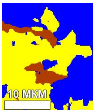
Рисунок 1.13 - Ориентационная карта в рекристаллизационном компоненте. ДОЭ. Синий – рекристаллизованные зерна, желтый – субструктурированные зерна, красный – деформированные зерна.
